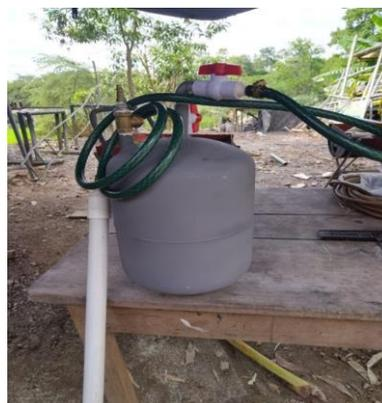
Fig. 1. Dosificador de espuma. Fuente: autores
